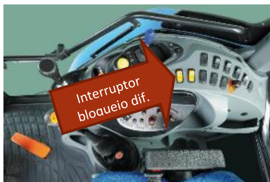
Imagem 24 – acionamento do bloqueio diferencial no trator
