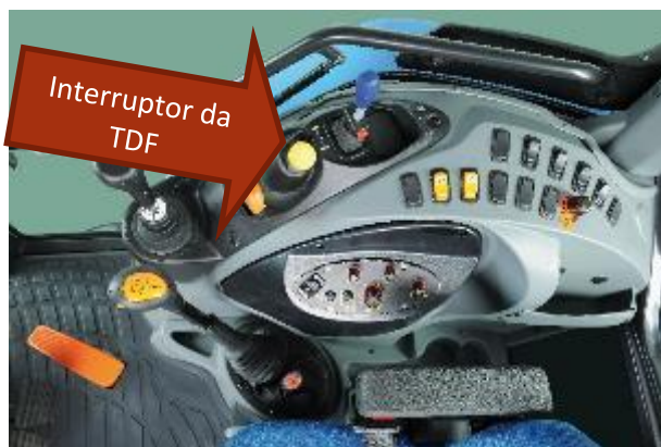
Imagem 32 – Interruptor elétrico da TDF na cabine do trator
