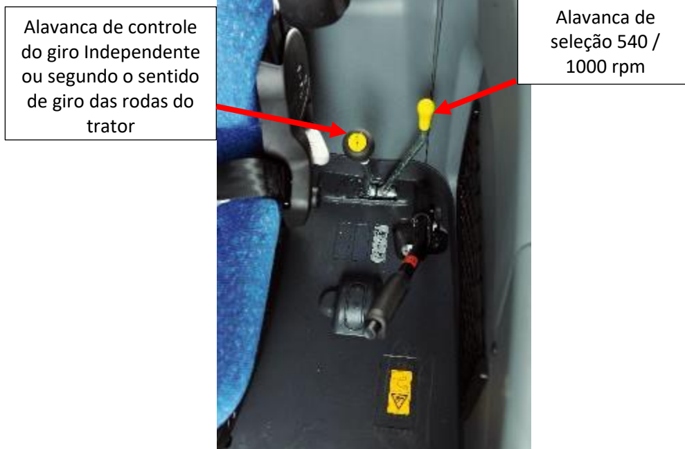
Imagem 36 – Alavancas de controle da rotação e do sentido de giro da TDF na cabine do operador
