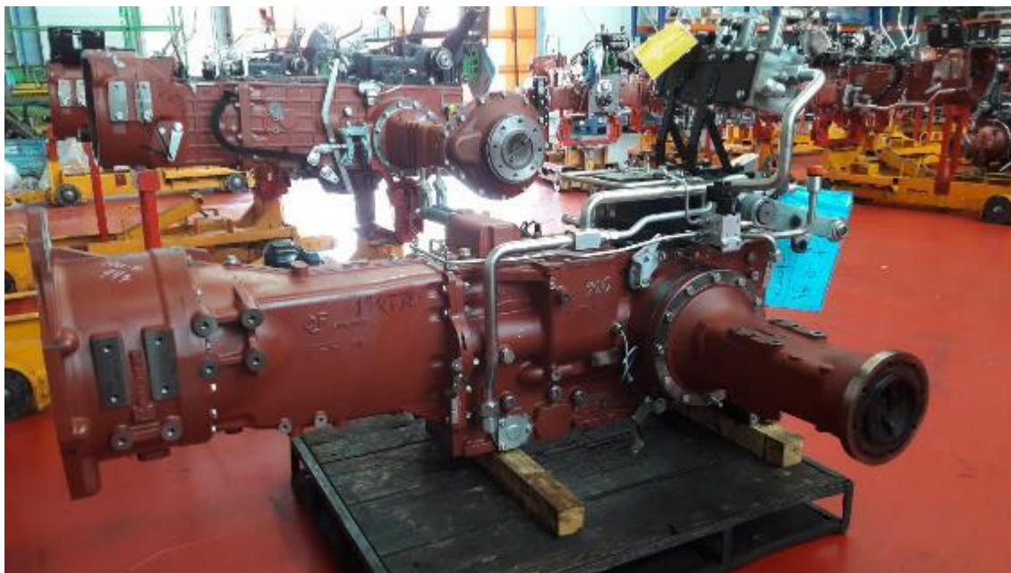
Imagem 5 - Vista pela lateral LD das Caixas de transmissão semiautomáticas 48F + 16 R código TRA00002
