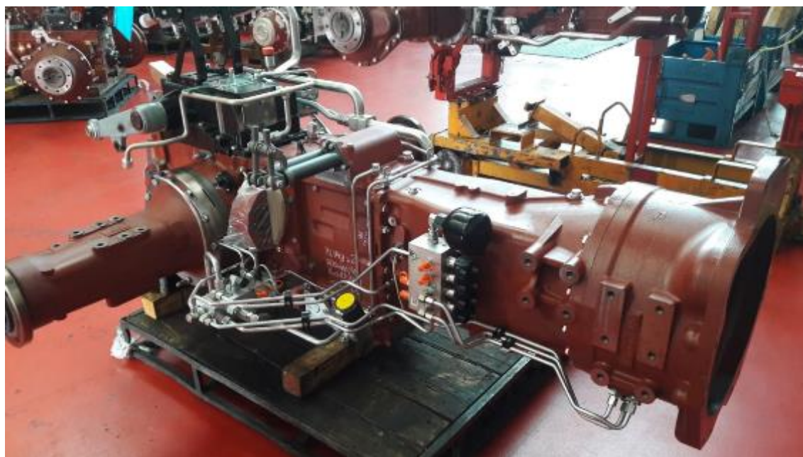
Imagem 4 - Vista pela lateral LE das Caixas de transmissão semiautomáticas 48F + 16 R código TRA00002
