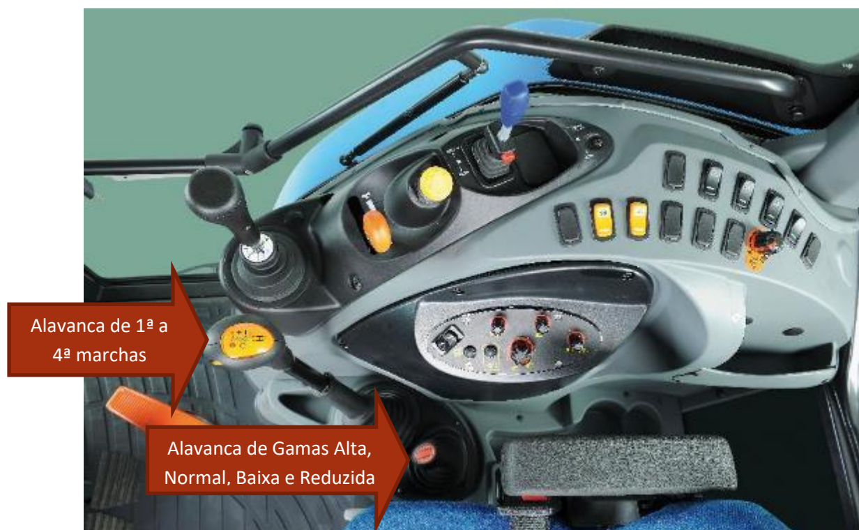
Imagem 10 - Vista das alavanca de 1ª a 4ª marchas e da alavanca de gamas Alta, Normal, Baixa e Reduzida
