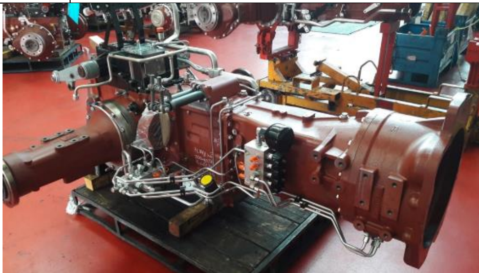
Imagem 1- Caixas de transmissão semiautomáticas 48F + 16 R código TRA00002, para tratores agrícolas de potências entre 82 kW e 90 kW
